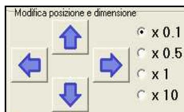
E' possibile **modificare la posizione e la dimensione** del pivot selezionato. Le frecce permettono di spostare il *Nord centro* (frecce SU e GIU') e l'*Est centro* (frecce DESTRA e SINISTRA). I valori di spostamento (in metri) possono essere modificati nella parte a lato.
