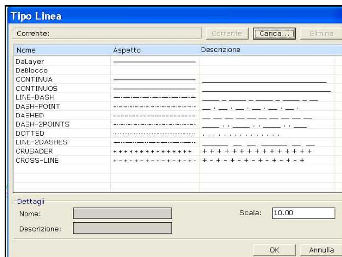
L'opzione **Carica** permette di caricare tipi di linea diversi registrati in un file di tipo **\*.LIN**. AgriCAD PC memorizza sul computer il file LINEE.LIN contenente tutti i tipi di linea mostrati nell'immagine precedente.
