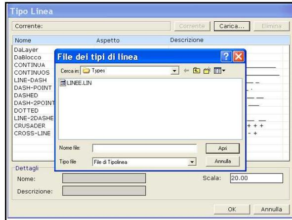
Il parametro **Scala** determina la dimensione della linea stessa rispetto al disegno di lavoro.
